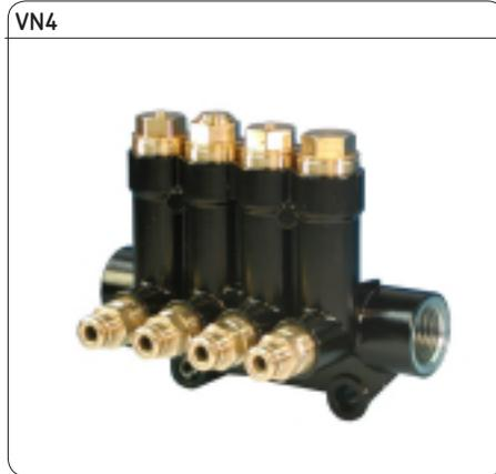
Eine Manschette (Wechselventil) im Verteiler verschließt während des Förderhubes den Auslass zur Schmierstelle, sodass der Schmierstoff unter dem Kolben gespeichert wird. Tritt der Druckabfall im Hauptleitungsnetz ein, d.h., das Entlastungsventil der Pumpe öffnet, so gibt das Wechselventil die Austrittsöffnung frei.
