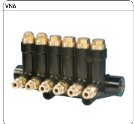
Die Schmierstellenleitung (Verbindung: Verteiler – Schmierstelle) erst dann an die Schmierstellen anschließen, wenn nach wiederholtem Betätigen der Pumpe blasenfreier Schmierstoff aus den Rohrleitungen austritt. Längere Schmierstellenleitungen eventuell vorfüllen.
