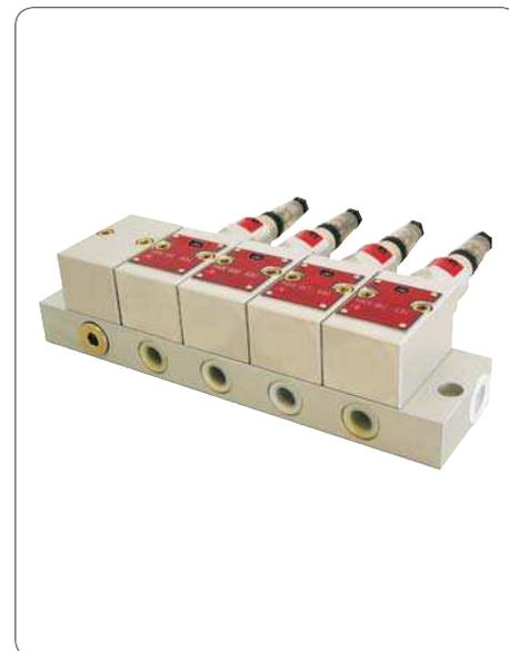
Mengenbegrenzer werden in Öl-Umlaufschmieranlagen eingesetzt. Hier haben sie die Aufgabe, den Volumenstrom der Hauptleitung in parallele Einzelvolumenströme aufzuteilen und diese bedarfsgerecht zu „begrenzen“ bzw. konstant zu halten.
