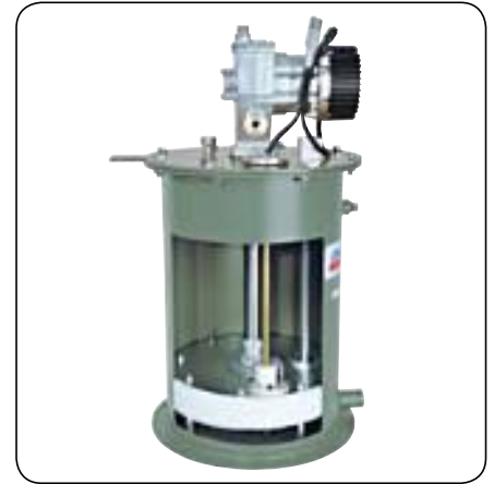
FlowMaster Pumpe und Behälter mit 50,8-mm-Folgeplatte mit Schaumstoffdichtung und Füllstandssensor
