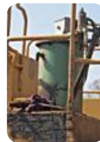
Nach dem Abschalten der Befüllpumpe kann am Steuergerät über einen Schalter zur Druckentlastung der Überdruck der Befüllleitung entspannt werden. Damit kann die Leitung sicher entkuppelt werden.
