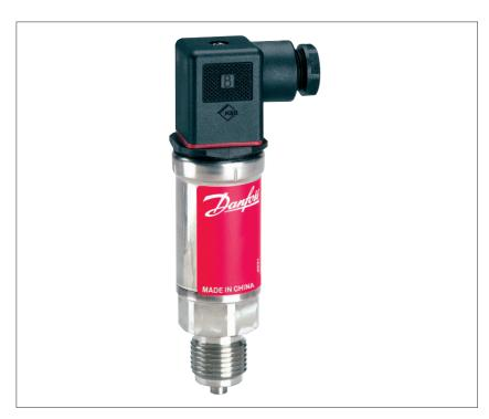
Der Standard-Heavy-Duty-Druckmessumformer MBS 4050 mit integriertem Pulsationsdämpfer wurde für Hydraulikanwendungen konzipiert, bei denen starke Medieneinflüsse wie Kavitation, Flüssigkeitsschläge oder Druckspitzen auftreten können und bietet selbst unter rauen Umgebungsbedingungen eine zuverlässige Druckmessung.
