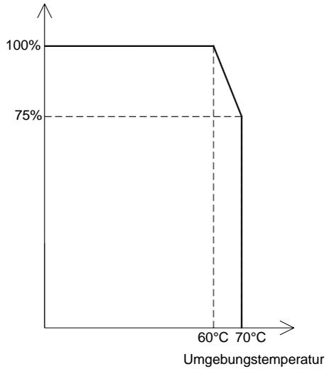
Um eine Überhitzung der Geräte zu vermeiden, muß die Verbraucherlast entsprechend reduziert werden.
