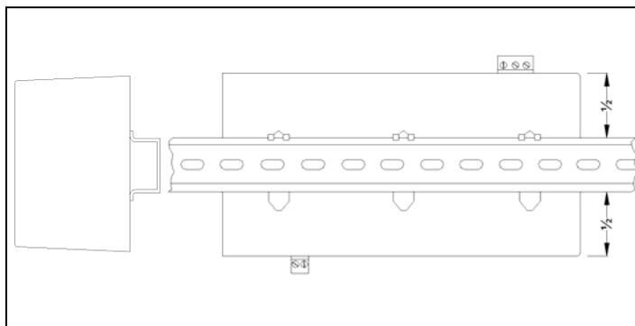
Freiraum zur Konvektion: Oberhalb und unterhalb des DCP2 100 mm, seitlich 30 mm
