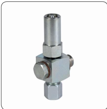
Um einen überhöhten Betriebsdruck im Schmiersystem zu verhindern, sollte ein geeignetes Druckbegrenzungsventil verbaut werden. Überschreitet der Betriebsdruck den Öffnungsdruck des Druckbegrenzungsventils, öffnet dieses und der Schmierstoff kann entweichen. Druckbegrenzungsventile stehen in den folgenden Varianten zur Auswahl:
